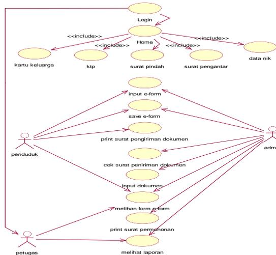
Gambar 2. Use Case Diagram Sistem Diusulkan
