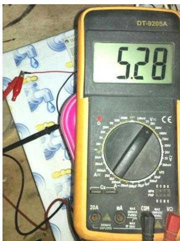
Gambar 4. Pengukuran tegangan Volt DC
