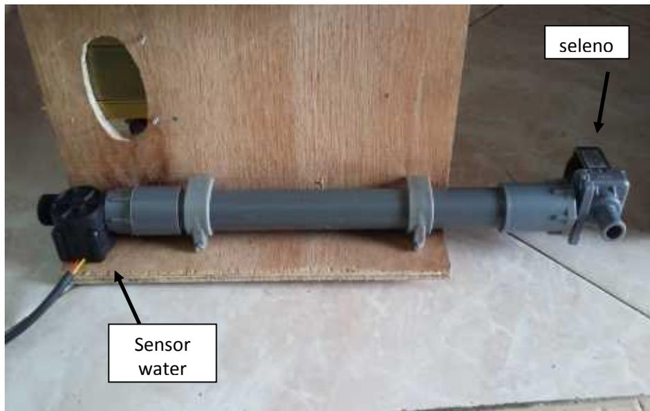
Gambar 7.1. Penampang dan Sensor Water Flow
