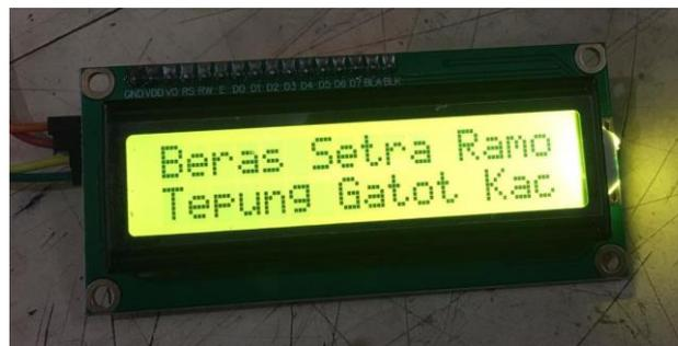
Gambar 3.4 Rangkaian alat LCD 2x16
